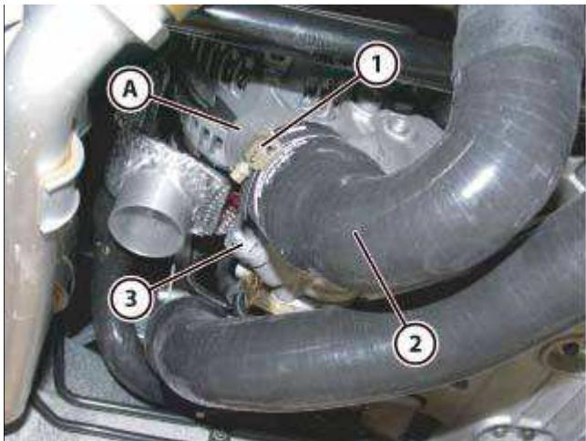
当重新安装时，在新衬垫上涂抹一层润滑脂 **SEGO** 之后，将衬垫重新放到盖罩与压力开关/节温器之间。
